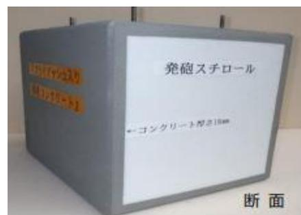
写真-3 コンクリート製フロートの構造
