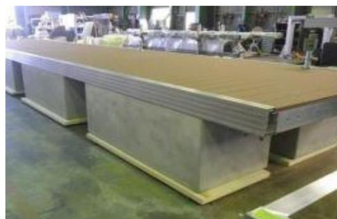
写真-4 コンクリート製浮栈橋
