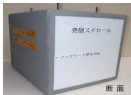
写真-3 コンクリート製フロートの構造
