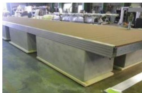
写真-4 コンクリート製浮栈橋
